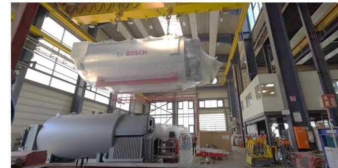
H<sub>2</sub>-Dampfkessel mit einer Leistung von 12t/h für ein polnisches Chemieunternehmen (BOSCH)
