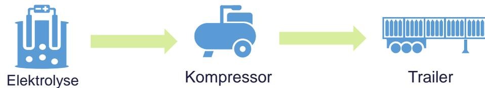
Bei einem externen Wasserstoffbezug wird der Wasserstoff für den Transport komprimiert. Dies führt zu Aufwänden von ca. 60 ct/kg<sub>H2</sub>. Diese Aufwände sind an der HRS nicht mehr zu erbringen.
