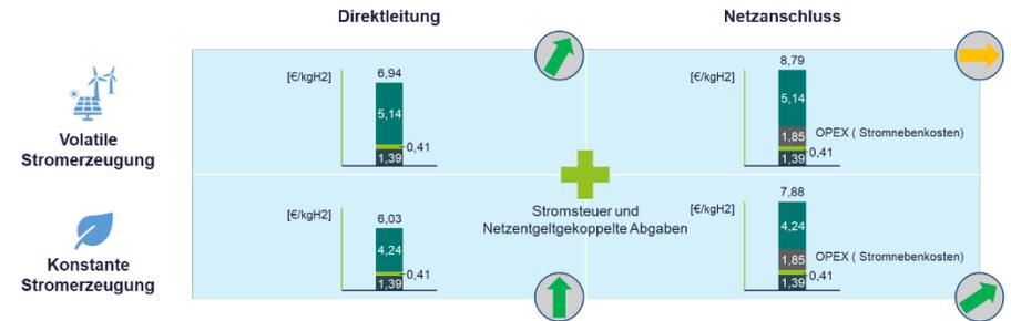
Abbildung 16: Matrix der Parameter für die wirtschaftliche Erzeugung erneuerbaren Wasserstoffs mit Gestehungskosten
