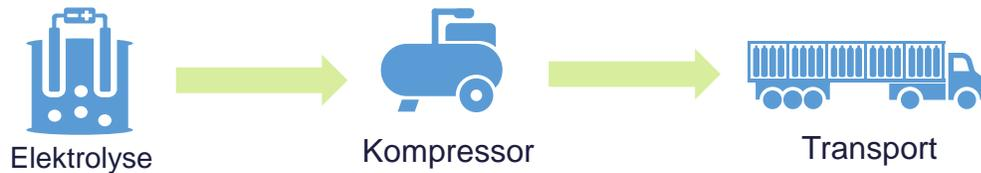
Der Trailer dient zugleich als mobiler Speicher der HRS. Somit sinken die CAPEX für Speicher an der HRS.
