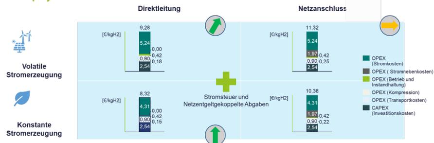
Abbildung 22: Beispielhafte Wasserstoffgestehungskosten eines Verbundprojektes
