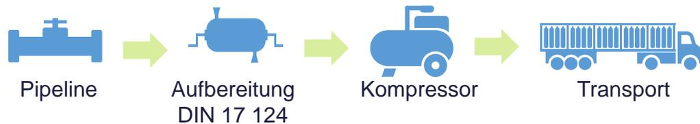
Für die Nutzung in Brennstoffzellenfahrzeugen ist eine Reinheit des Wasserstoffs entsprechend der DIN 17 124 notwendig. Da durch einen Pipelinetransport der Wasserstoff verunreinigt werden kann, könnte eine zusätzliche Reinigung des Wasserstoffs notwendig werden<sup>1</sup>.
