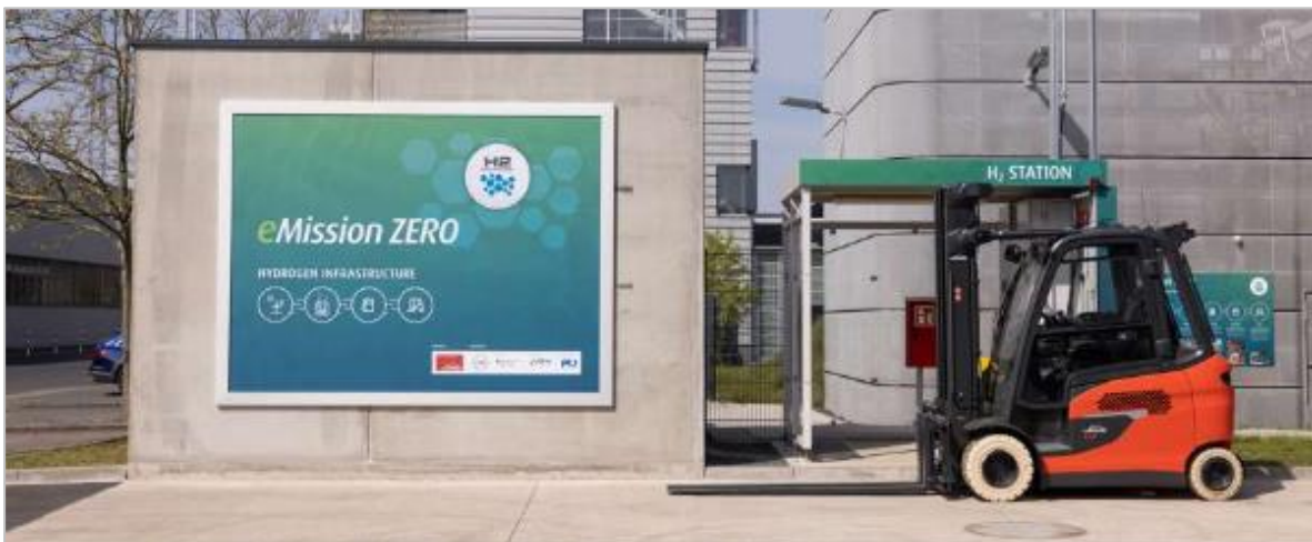
Abb. 52: Wasserstoff-Tankstelle und BZ-Stapler der LINDE Material Handling GmbH in Aschaffenburg
