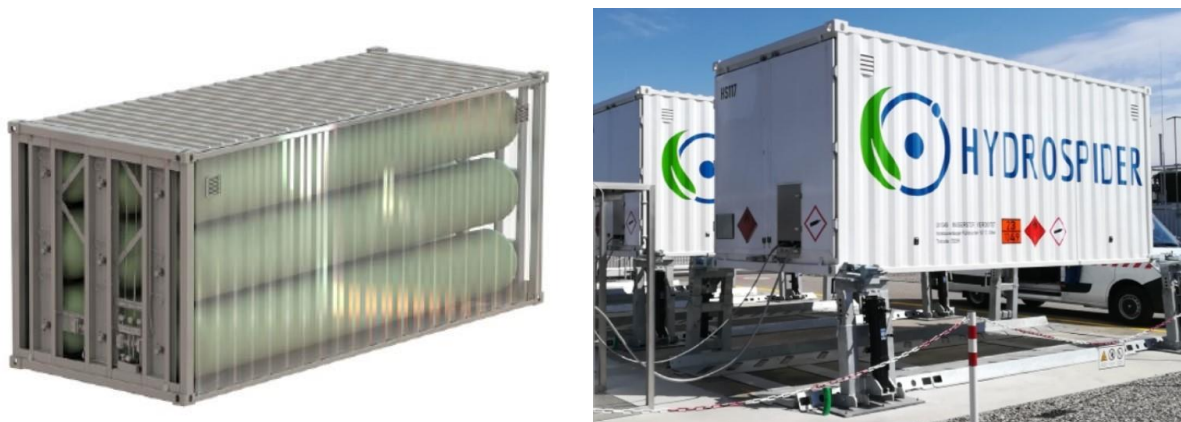
Abb. 91: Wechselcontainersystem der Firma Vernconex, Schweiz. 20 Fuß-Container speichern ~350 kg H 2 bei 350 bar
