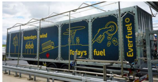
Trailer Druckflaschen stehend 500 bar ≈ 1.000 - 1.300 kg 380 bar ≈ 1.000 kg 300 bar ≈ 800 - 1.000 kg
