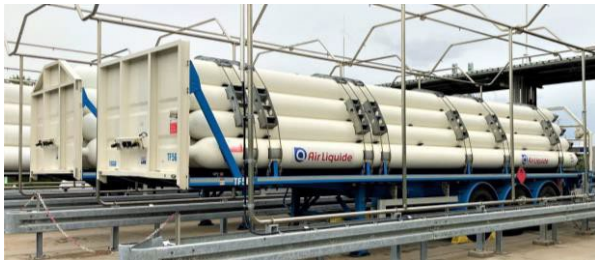
Trailer Druckflaschen liegend 200-250 bar ≈ 500 kg
