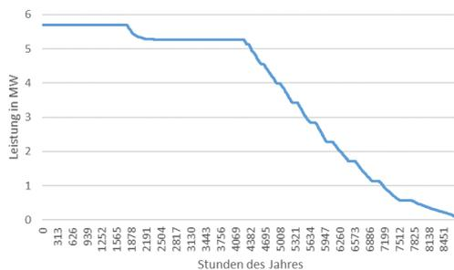
Abbildung 12: Volllaststunden des Elektrolyseurs (1) am Windpark mit 7,6 MW
