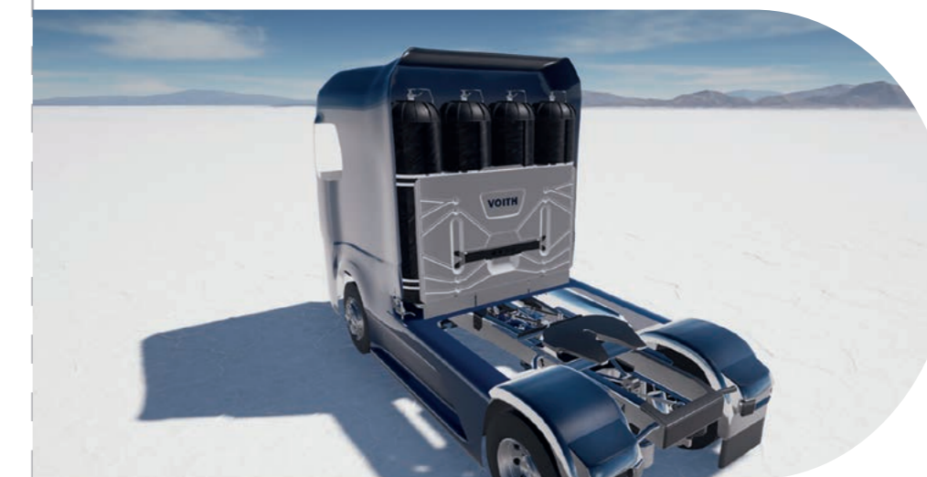
Voith Wasserstoff-Antriebsstrang mit H 2 -Storage-System (Plug and Drive) und Voith Electrical Drive System 2.0. © J.M. Voith SE & Co. KG | VTA
