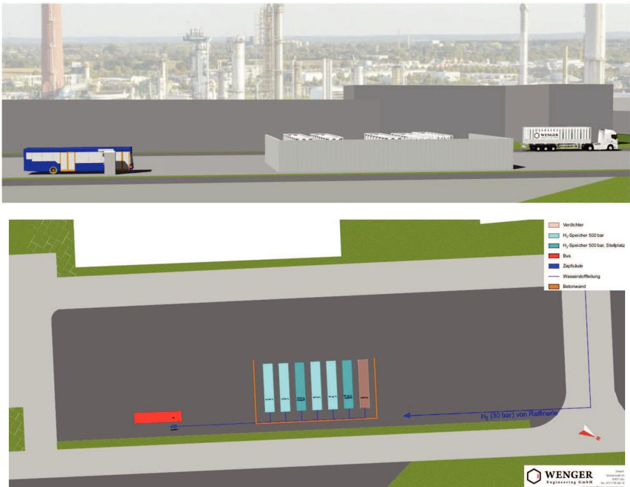
Abbildung 5: Möglicher Aufbau der Trailer-Abfüllstation
