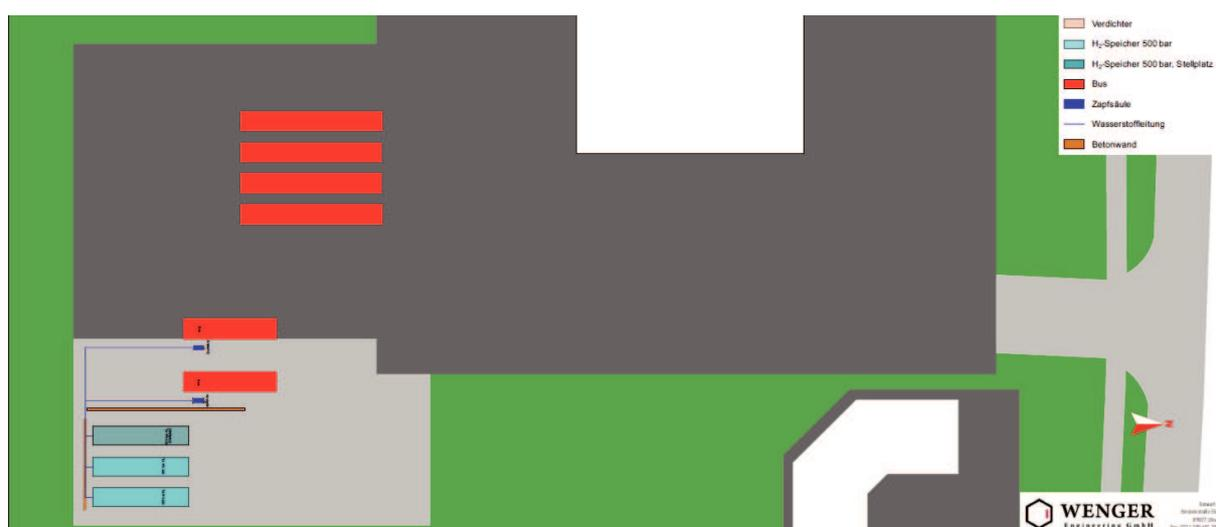
Abbildung 7: Möglicher Aufbau einer Trailer-Tankstelle
