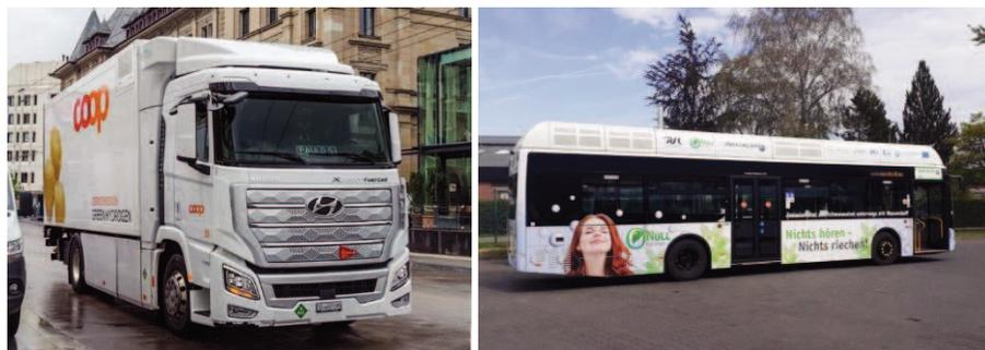
Abbildung 18: Schwere Nutzfahrzeuge mit Brennstoffzellen<sup>41</sup>
