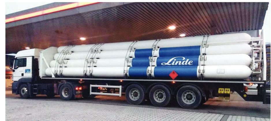
Abbildung 11: Wasserstofftrailer mit Röhrenspeicher
