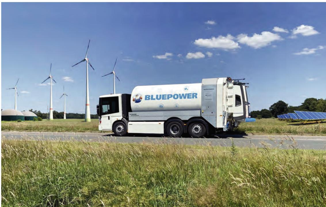
Abfallentsorgungsfahrzeuge mit Brennstoffzellenantrieb von Faun (Bild von Faun Webseite)
